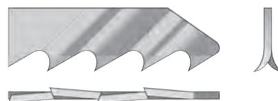
**Cónico:** os dentes são retificados cilíndricamente, em forma de cone. Com um dentado com retificação cilíndrico obtém-se um corte fino em madeira e material sintético.
